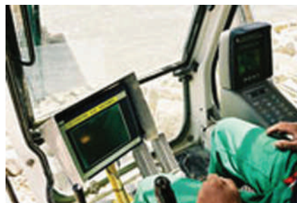
Figure 8 – Cabine d'un engin équipé d'un ordinateur embarqué et du guidage GPS (Photothèque GTM Construction/Patrice Lefebvre)
